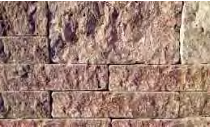
CHAMBERY ROSSO ANTIK zweihäufig gespalten und getrommelt, Kanten gesägt | rot-weiß double faces brutes et tamisées, bords sciés | rouge-blanc due lati visti a spacco burattati, coste segate | rosso-bianco Art.-Nr. 100317 | 30-60 x 20 cm | 540 kg/m 2 Schichthöhen hauteur de couche altezze varie 7,5/15/22,5 cm
